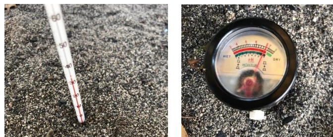
Gambar.3 Pengukuran Suhu, pH dan Kelembapan
