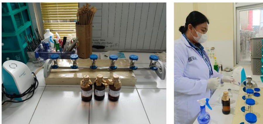
Gambar 2. Perangkat Uji Kualitas Air Metode Membran Filter
